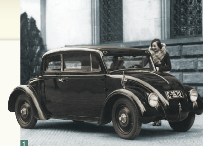
1. ŠKODA 932 оснащалась хребтовой рамой, а 30-сильный двигатель располагался сзади 2. За период с 1931 по 1934 год было реализовано 504 экземпляра ŠKODA 633
